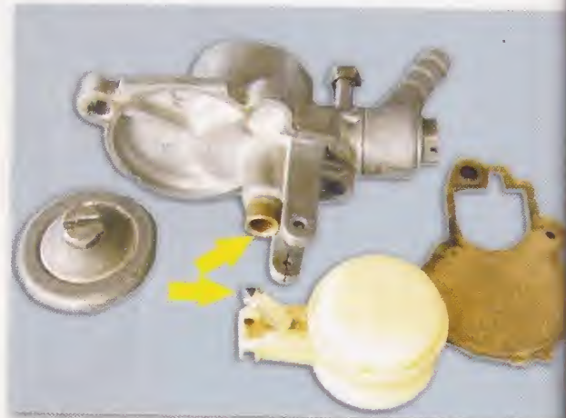
Despiece del circuito de llenado
